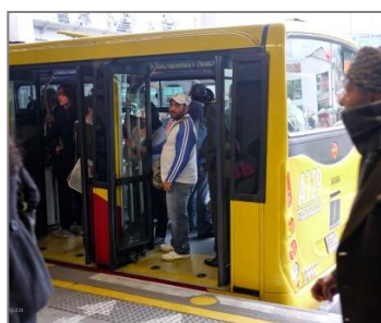
Esquerda: Vão entre veículo e plataforma aumenta o tempo de embarque e o risco de acidentes. Centro: Vão mínimo em Bogotá. Direita: Sistema de ponte de embarque em Quito. Fotos: ITDP
