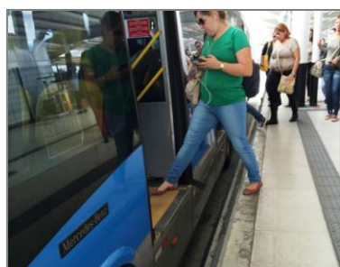
Esquerda: Vão entre veículo e plataforma aumenta o tempo de embarque e o risco de acidentes. Centro: Vão mínimo em Bogotá. Direita: Sistema de ponte de embarque em Quito. Fotos: ITDP
