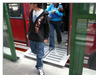
Esquerda: Vão entre veículo e plataforma aumenta o tempo de embarque e o risco de acidentes. Centro: Vão mínimo em Bogotá. Direita: Sistema de ponte de embarque em Quito. Fotos: ITDP
