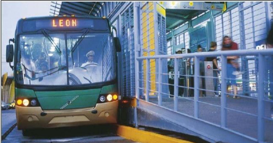
Figura 4.2 – Veículo de piso alto em conjunto com embarque de plataforma em nível no Sistema BRT Optimus da cidade de Leon, México (MINISTÉRIO DAS CIDADES/ITDP, 2008).
