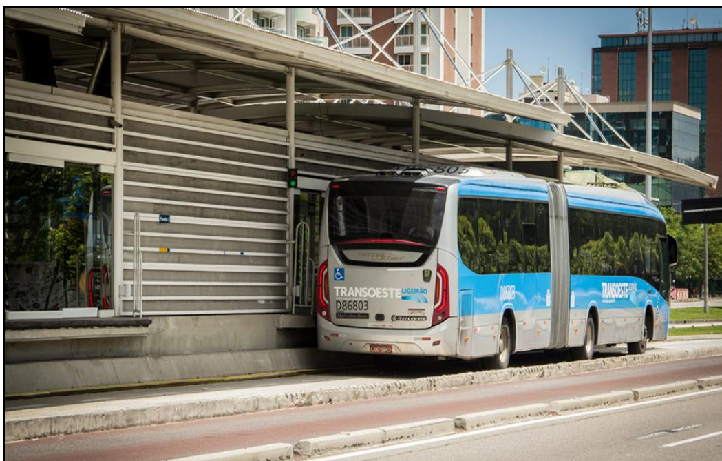
Figura 4.7 – Ônibus articulado do BRT Transoeste posicionado na estação para embarque de passageiros. Verifica-se a elevação da estação para o embarque em nível dos passageiros (BRT RIO, 2014).
